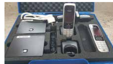
Notrufübungsanlage - schnurlose Telefone arbeitet autark
